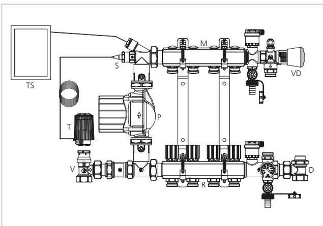
Клапан V и распределитель D представляют собой точки подсоединения к первичному высокотемпературному контуру. Через клапан поступает поток теплоносителя под температурой 70÷80°C, а из распределителя D поступает в возврат подстанции подача, равная входной подаче из клапана V, но под температурой, равной температуре возврата из установки на излучающих панелях. На клапане смонтирована лимитирующая температуру термостатическая головка T, имеющая свой
