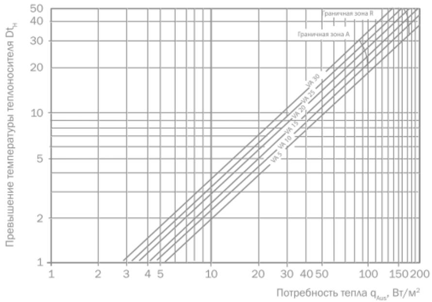
**Диаграмма определения температуры поверхности пола.**
