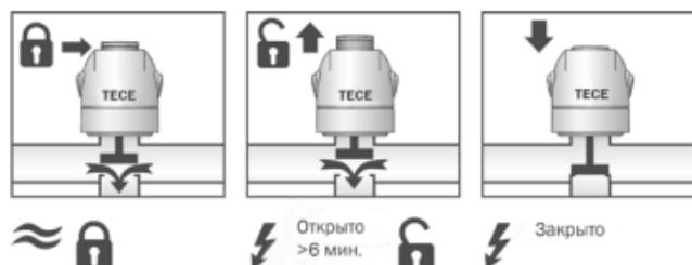
Перед установкой сервопривода на вентиль следует отделить от упаковки этикетку, нанести на нее маркировку помещения и отопительного контура и поместить ее на сервопривод. Далее навернуть резьбовой адаптер сервопривода на терmostатический вентиль и затянуть с усилием. После этого подключить сервопривод к коммутационной коробке.
