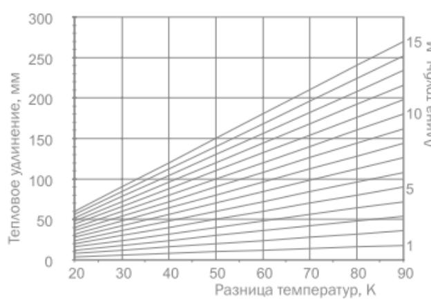
Температурное удлинение для труб PE-Xc и PE-MDXc TECEflex
