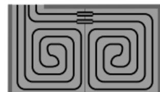
Схема укладки трубопровода при наличии расширительных швов
