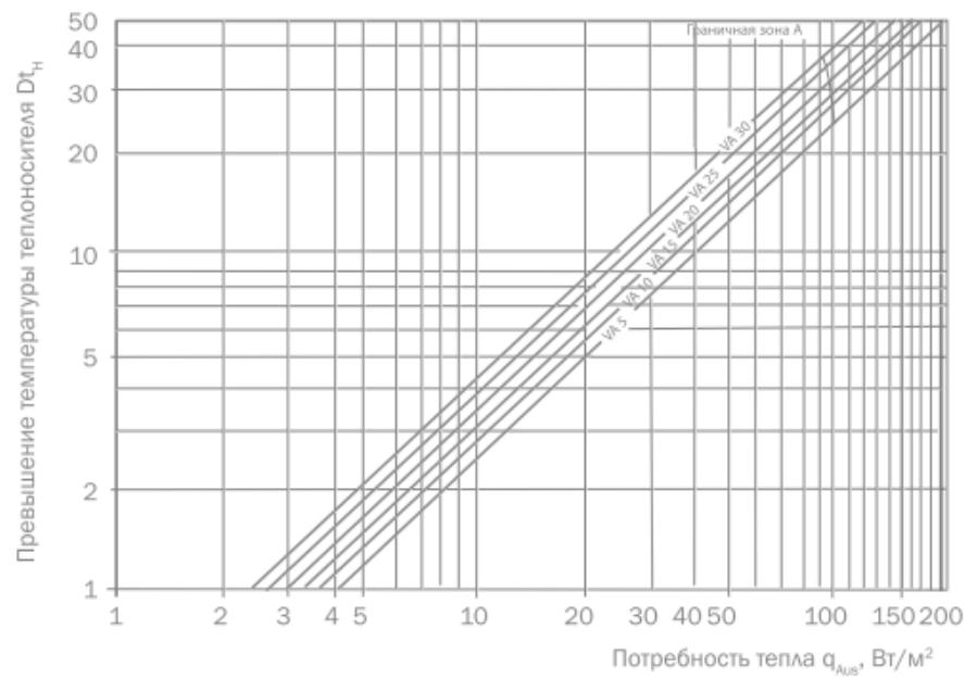
**Диаграмма определения температуры поверхности пола.**
