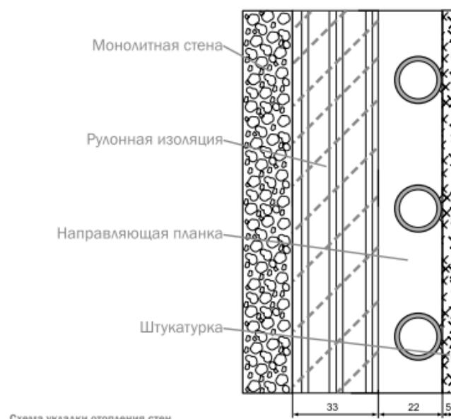
Схема укладки отопления стен
