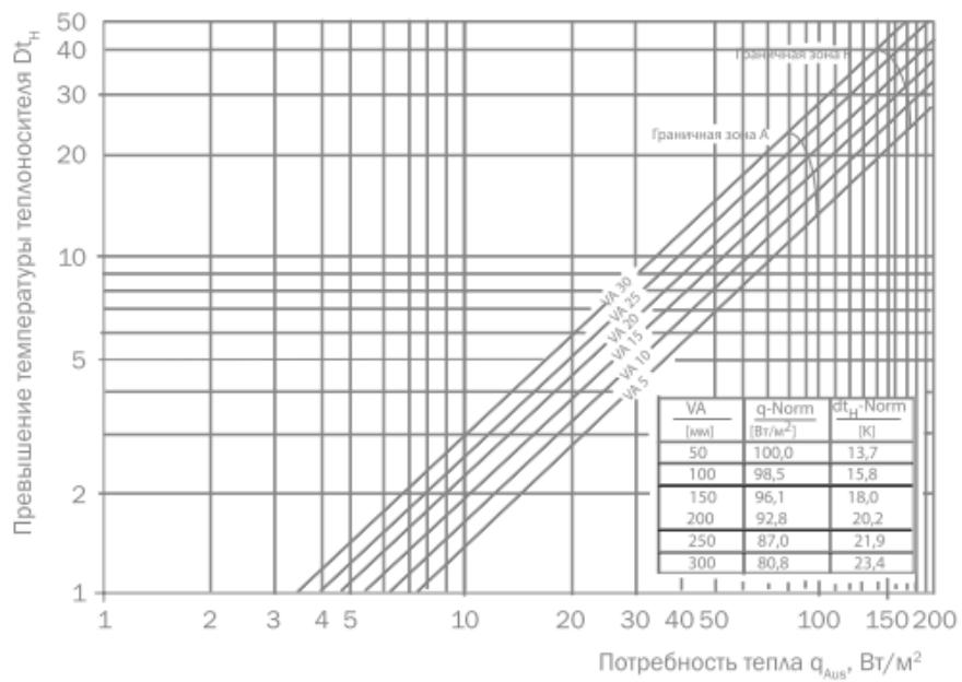
Диаграмма определения температуры поверхности пола.
