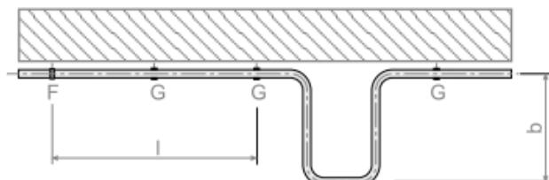
Пример оборудования компенсатора на прямолинейном участке трубопровода
