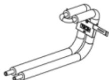
При использовании данного подключения возможно вести монтаж без установки радиаторов на стену, т.к. монтажные пластины выполнены по байпасной схеме (оборудован перемычкой из трубы d=16 мм U-образной формы), что делает возможным проведение гидравлических испытаний.
