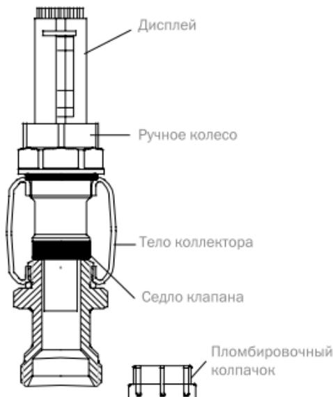
в соответствии с расчетами системы и диаграммой «Предварительная настройка распределителя отопления пола TECEflex». Диапазон регулировки клапана от 0,5 до 5,0 л/мин. Максимальная температура теплоносителя 70 °C.
