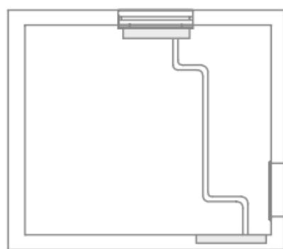
Пример прокладки трубопровода от распределителя к радиатору
