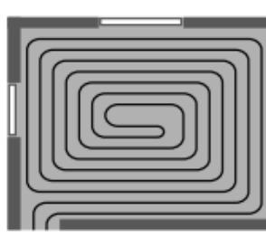
Укладка трубопровода в форме улитки
