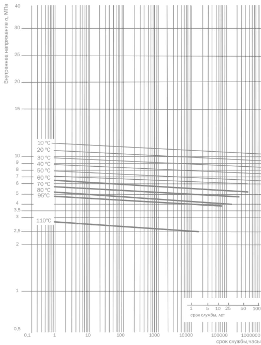
Эталонные кривые длительной прочности многослойных труб из PE-MDXc.
