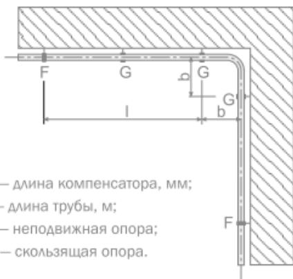
Пример оборудования компенсатора при смене направления трубопровода
