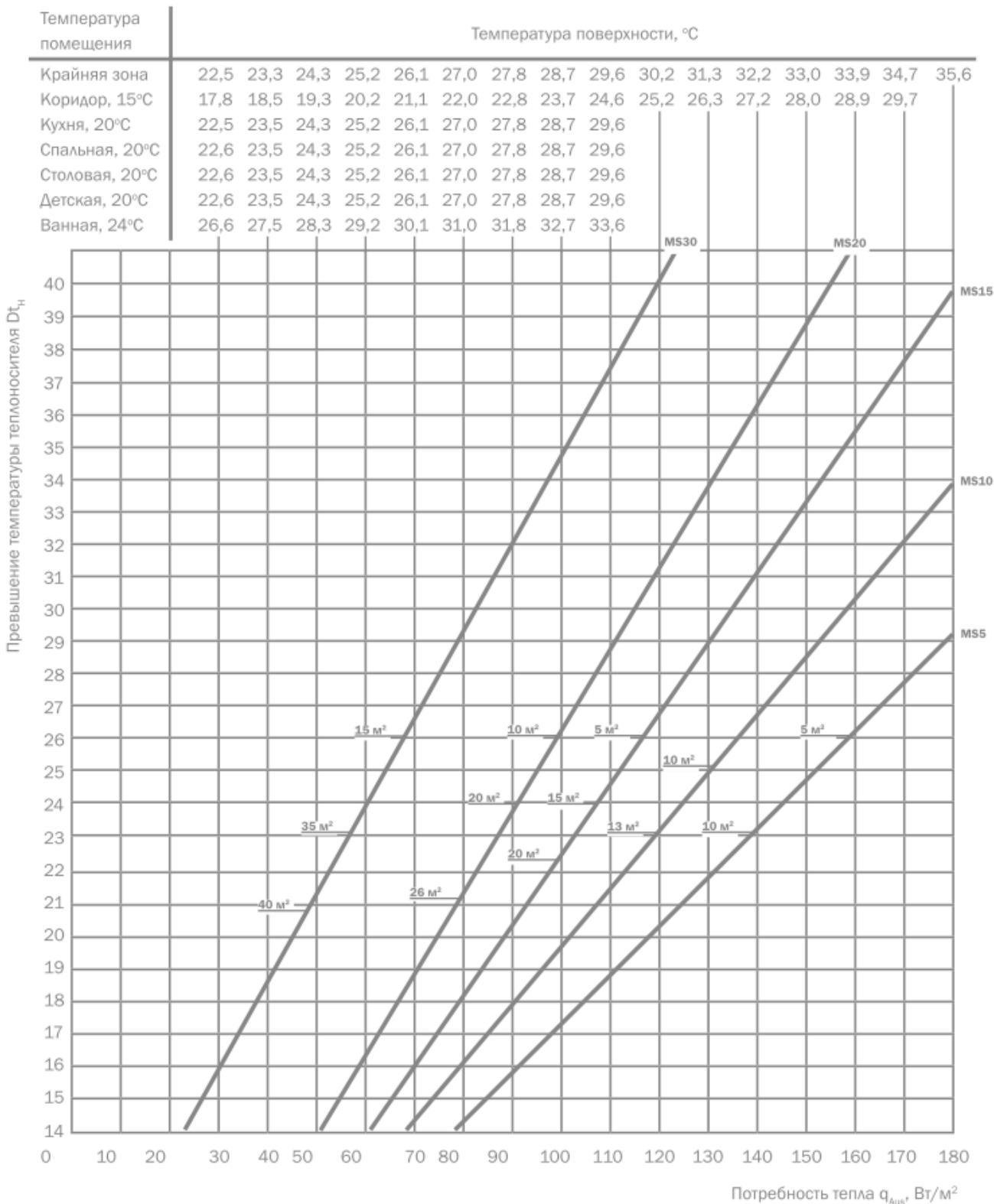
**Диаграмма определения температуры поверхности пола.**
