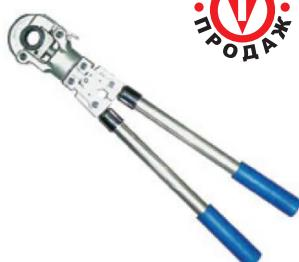
Предназначены для ручной опрессовки гильз пресс-соединителей трубопроводных систем из пластика, металлополимера, меди и тонкостенной нержавеющей стали. Клещи комплектуются пресс - насадками (16-20-26-32) с профилем «ТН».
