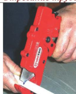
При выполнении реза роликовым, сабельным или гильотинным труборезом, труба должна без перекоса опираться на плоскость инструмента, противоположную режущему органу, в этом случае разрез будет произведен строго по плоскости, перпендикулярной оси трубы. В случае, когда инструмент сильно сминает трубу при резке, режущий орган необходимо заточить или заменить.
