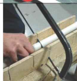
Разрезание металлополимерной трубы ножовкой допускается только с применением стусла.
