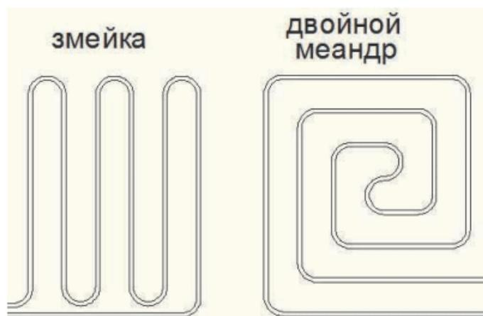
Трубы теплого пола нужно раскладывать таким образом, чтобы теплоноситель сначала поступал к наиболее холодным зонам помещения (окна, наружные стены). У стен , вдоль которых планируется расстановка мебели, трубы теплого пола следует укладывать на расстоянии 300 м от стены.
