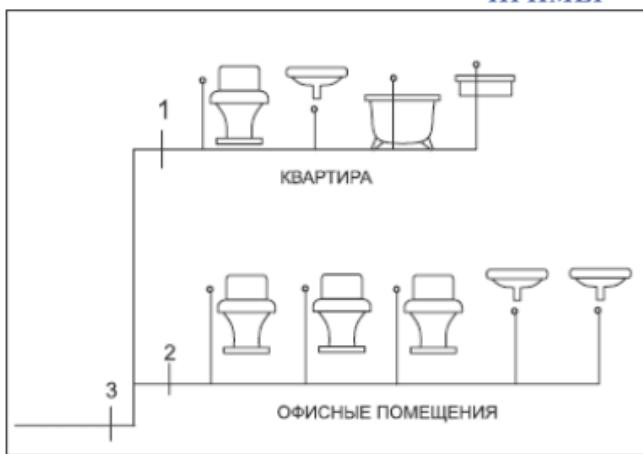
Имеется участок сети, который обслуживает жилую квартиру и офисное помещение. В квартире установлено: унитаз, ванна, умывальник, мойка.
