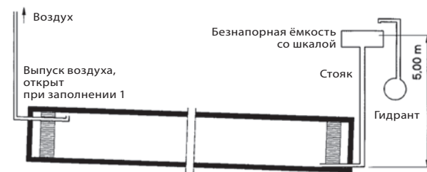
Рис. 10 Проверка герметичности
